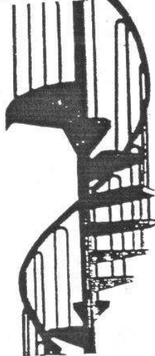
Art. 380 SCALA A CHIOCCIOLA in acciaio verniciato colore bianco crema gradini rivestiti in gomma nera oppure in moquette grigia da Ø1000 a 2000 = H 2100 a 3979 (il Ø del foro deve essere maggiorato di mm. 100)
